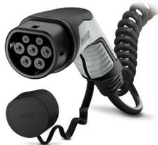
CHARX connect, AC-Ladeleitung mit Fahrzeug-Ladestecker und offenem Leitungsende, Gehäusefarbe schwarz-grau, mit Schutzkappe, zum Laden mit Wechselstrom (AC) von Elektrofahrzeugen (EV) mit Typ 2 Fahrzeug-Inlets, zur Installation an Ladestationen für die Elektromobilität (EVSE), Typ 2, IEC 62196-2, 20 A / 250 V (AC), C-Line, "PHOENIX CONTACT"-Logo, Kabel: 4 m, schwarz, spiralisiert, Gehäuse:
