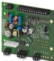
Die Ladesteuerung EV-CC-AC1-M3-CC-SER-PCB als Leiterplatte dient zum Laden von Elektrofahrzeugen am 3-Phasen-Wechselstromnetz nach IEC 61851-1, Mode 3. Optimiert für Ladestationen mit fest montiertem Fahrzeug-Ladestecker. Alle Ladefunktionen und umfangreiche Konfigurationseinstellungen sind bereits integriert.
