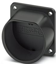
CHARX connect, Ladesteckerhalterung, Parkposition, für Fahrzeug-Ladestecker an Ladestationen (EVSE), Typ 2, IEC 62196-2, Vorderwandmontage, Frontneigung 0 ° bis 45 ° möglich, D-Line, "PHOENIX CONTACT"-Logo
